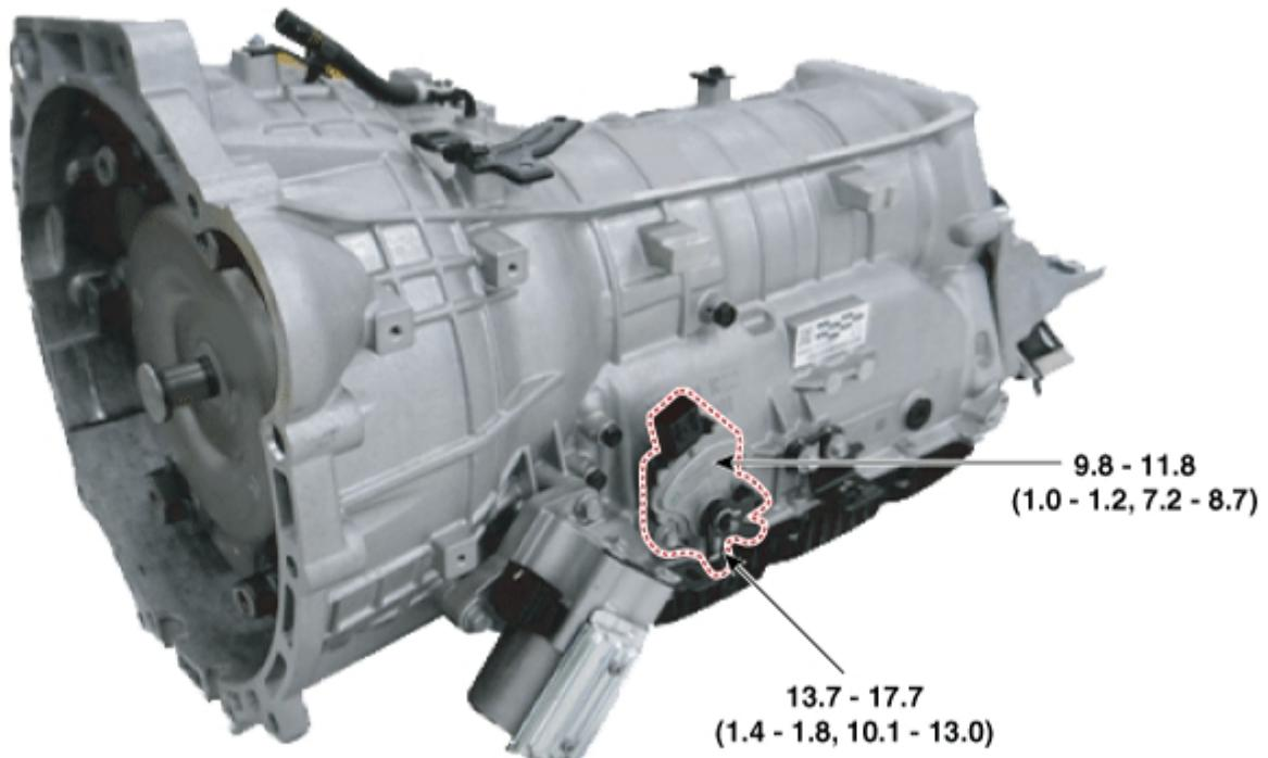
Tightening torque : N·m (kgf·m, lb·ft)
